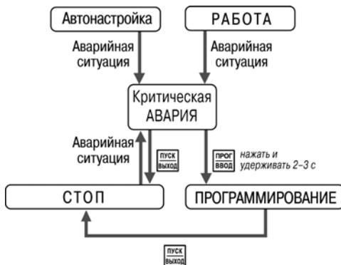
Рисунок 8.2 - Схема переключения режимов при Критической АВАРИИ
