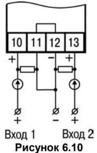
**ВНИМАНИЕ!** «Минусовые» входы датчиков в приборе электрически объединены между собой.
