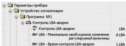
Для контроля LBA-аварии нужно задать «**время диагностики обрыва контура**» (параметр **t.LBA**) и значение «**минимального необходимого изменения регулируемого параметра**» (параметр **d.LBA**), которое должно произойти за это время.
