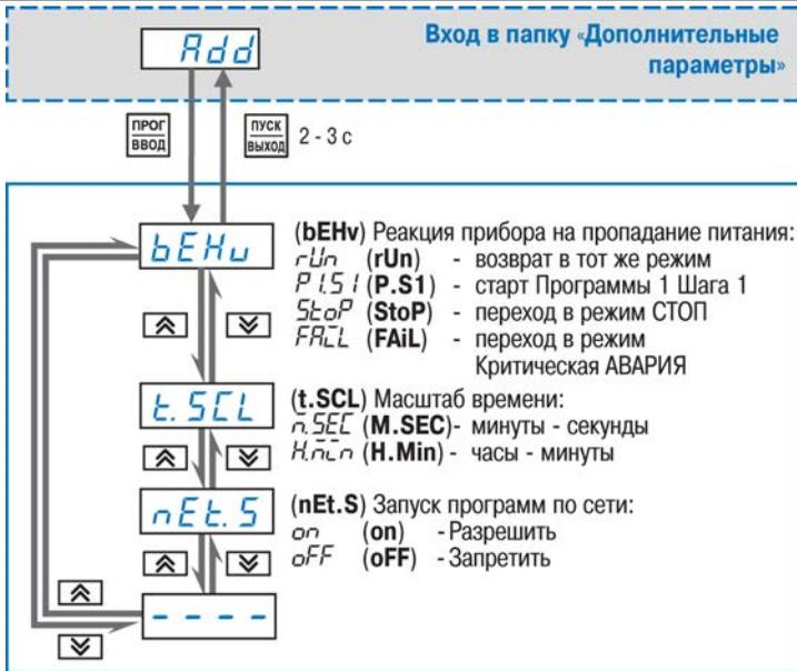
Рисунок 7.9 - Схема задания дополнительных параметров прибора
