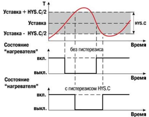
Рисунок 3.4 - Принцип работы двухпозиционного регулятора
