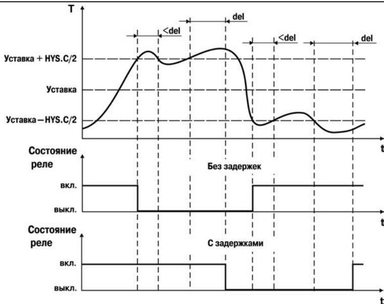
Рисунок 3.5 - Работа регулятора с заданными задержками
