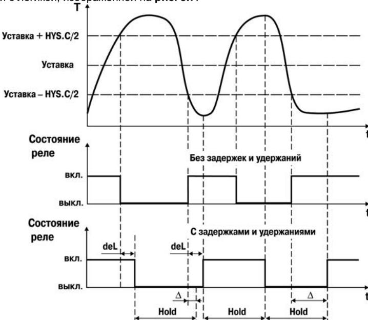
Рисунок 3.7 - Работа регулятора с заданными задержками и удержаниями
