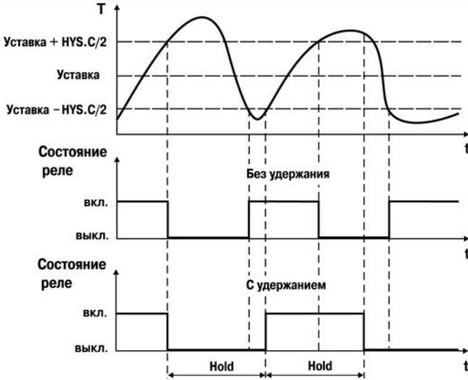
Рисунок 3.6 - Работа регулятора с заданным удержанием
