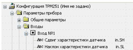
**Примечание** - При работе с платиновыми термометром сопротивления на заданное в параметре **in.SH** значение сдвига накладывается также коррекция нелинейности НСХ датчика, заложенная в программе обработки результатов измерения.
