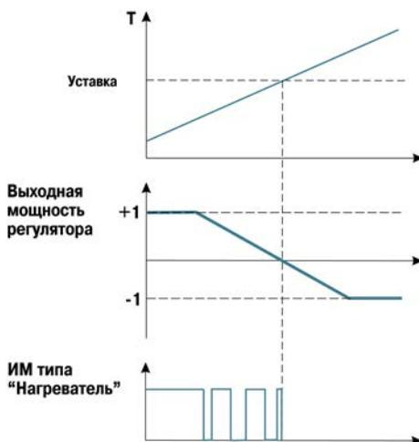
Рисунок 3.3 - Принцип формирования ШИМ-сигнала для «нагревателя»
