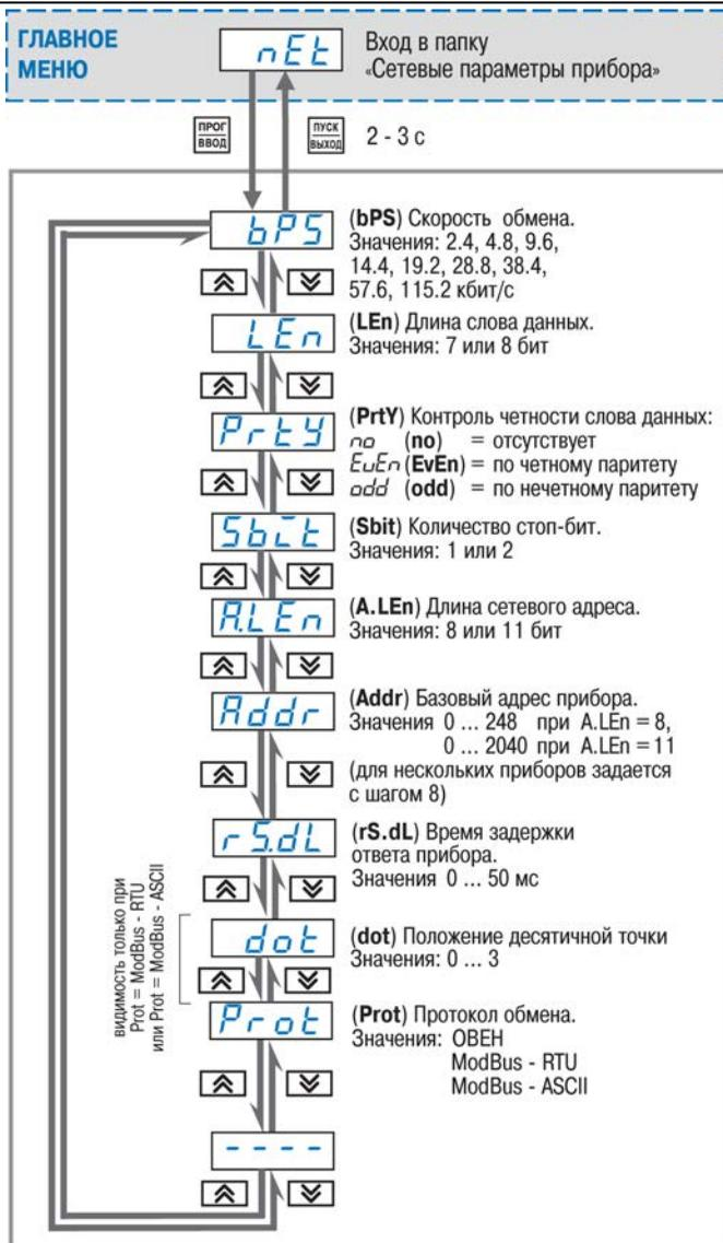
Рисунок 7.8 - Схема задания сетевых параметров прибора
