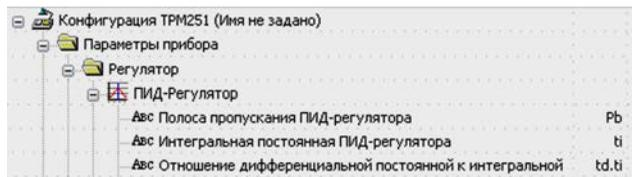
Настройку ПИД-регулятора рекомендуется выполнять в автоматическом режиме (см. п. 8.7). При настройке вручную пользователь может определить приблизительные значения параметров ПИД-регулятора по Приложению Ж.2.
