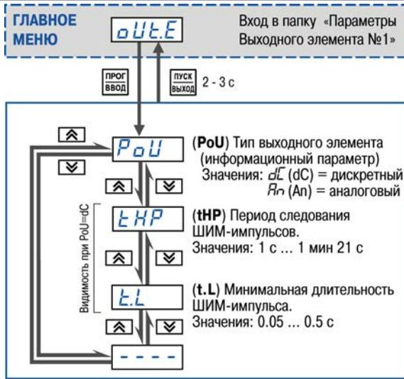
Рисунок 7.6 - Схема задания параметров Выхода 1
