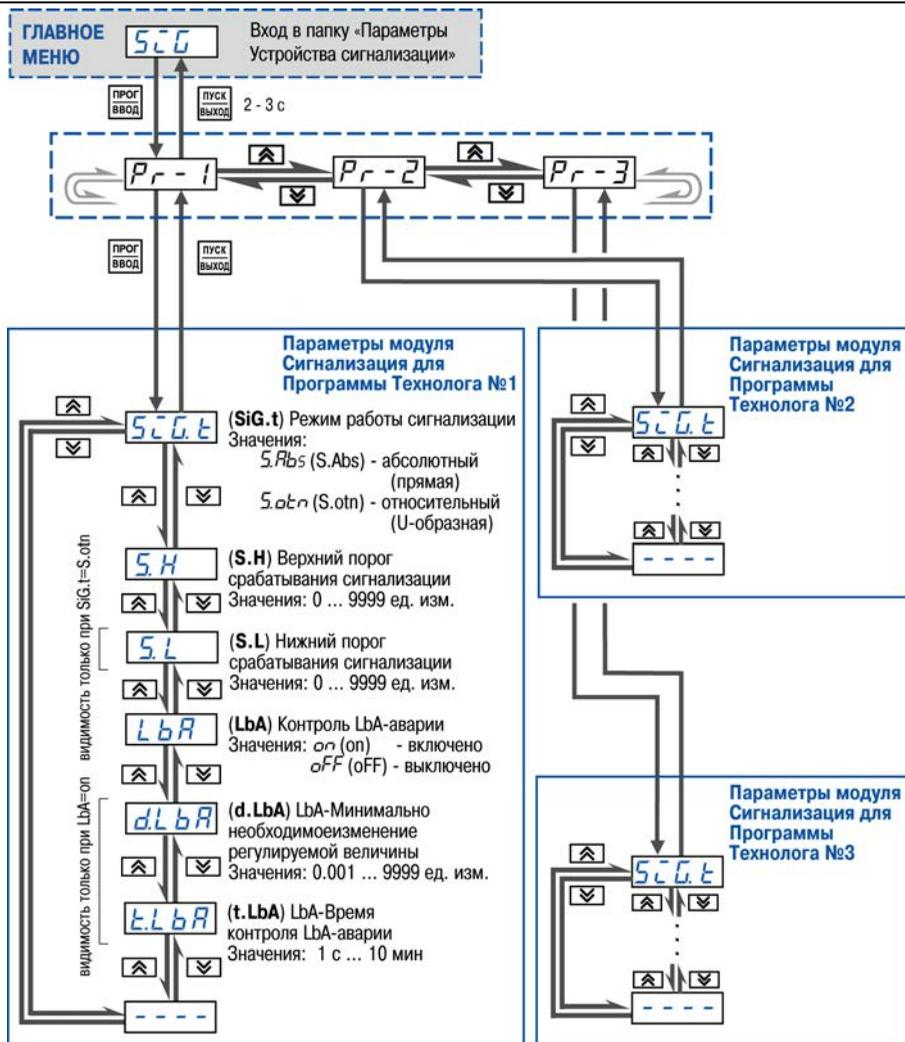
Рисунок 7.3 - Схема задания параметров Устройства сигнализации
