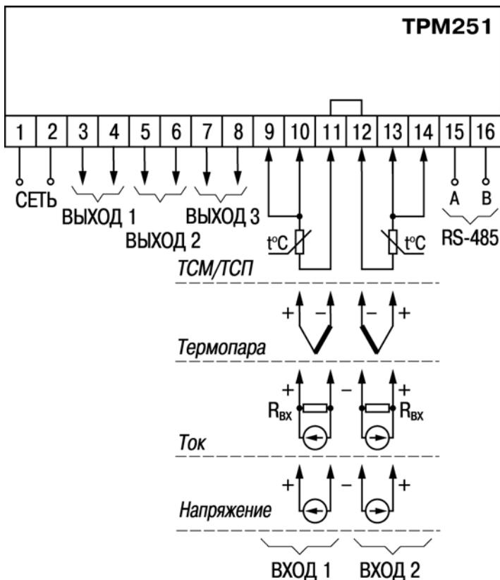
Рисунок Б.1 - Общая схема подключения TRM251
