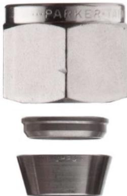
Посеребренная гайка фитинга служит для предотвращения коррозионного истирания резьбы. Внешний буртик промаркирован с указанием производителя Parker, размера, материала и теплового кода.
