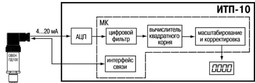
Рисунок 3.1 – Структурная схема прибора
