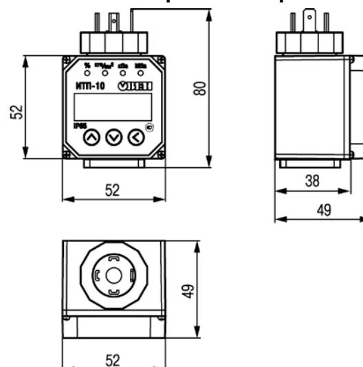
Рисунок А.1 – Габаритные и установочные чертежи прибора
