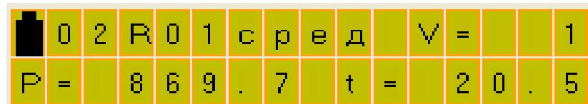
б) вывод плотности, температуры и вязкости 2-го измерения;
