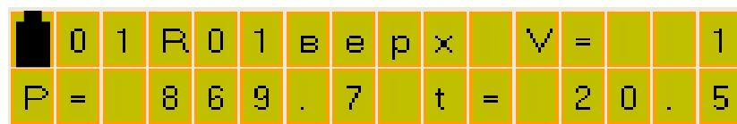
в) вывод плотности, температуры и вязкости 1-го измерения;
