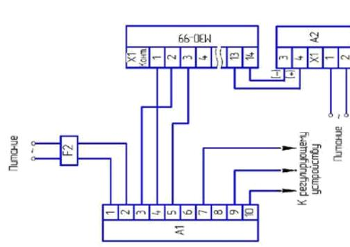
Рисунок Г.4 – Схема подключения механизма к однофазной сети при бесконтактном управлении
