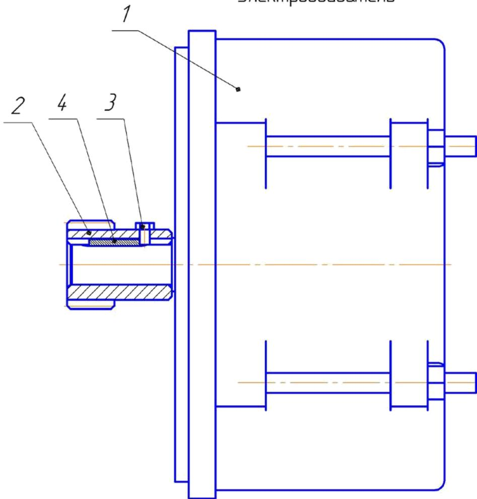
1 – электродвигатель; 2 – шестерня; 3 – винт; 4 – шпонка
