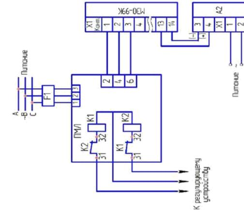
Рисунок Г.3 – Схема подключения механизма к трехфазной сети при контактном управлении
