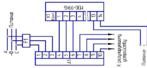
Рисунок Г.2 – Схема подключения механизма к трехфазной сети при бесконтактном управлении
