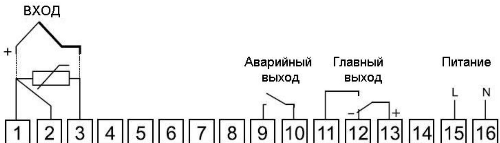
Рис.3. Описание зажимов клеммного ряда регулятора RE55
